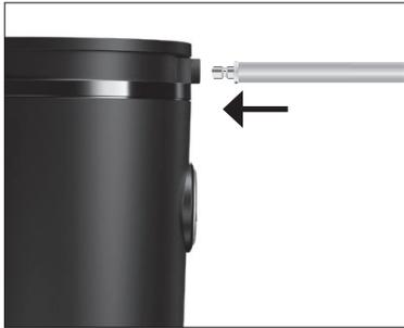
**i** Um den Milchschauch korrekt mit dem Adapter verbinden zu können, muss der Milchschauch mit einem Anschlussstück ausgestattet sein.
